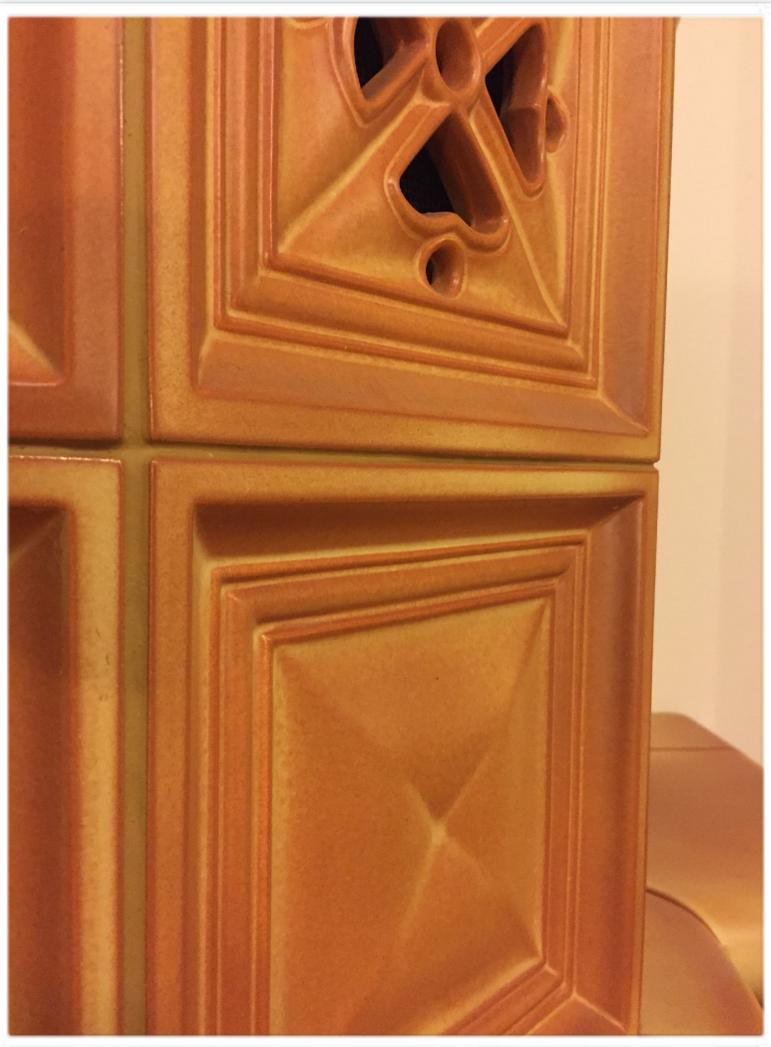
После этого, изразцы шлифуются под точный размер. Окончательные размеры (с **точностью до  $\pm 1$  мм**) получаются с помощью шлифовальных кругов и алмазных режущих дисков. После сушки, острые края округляются вручную. Поверхности отшлифовываются до безупречной ровности, а затем обеспыливаются.
